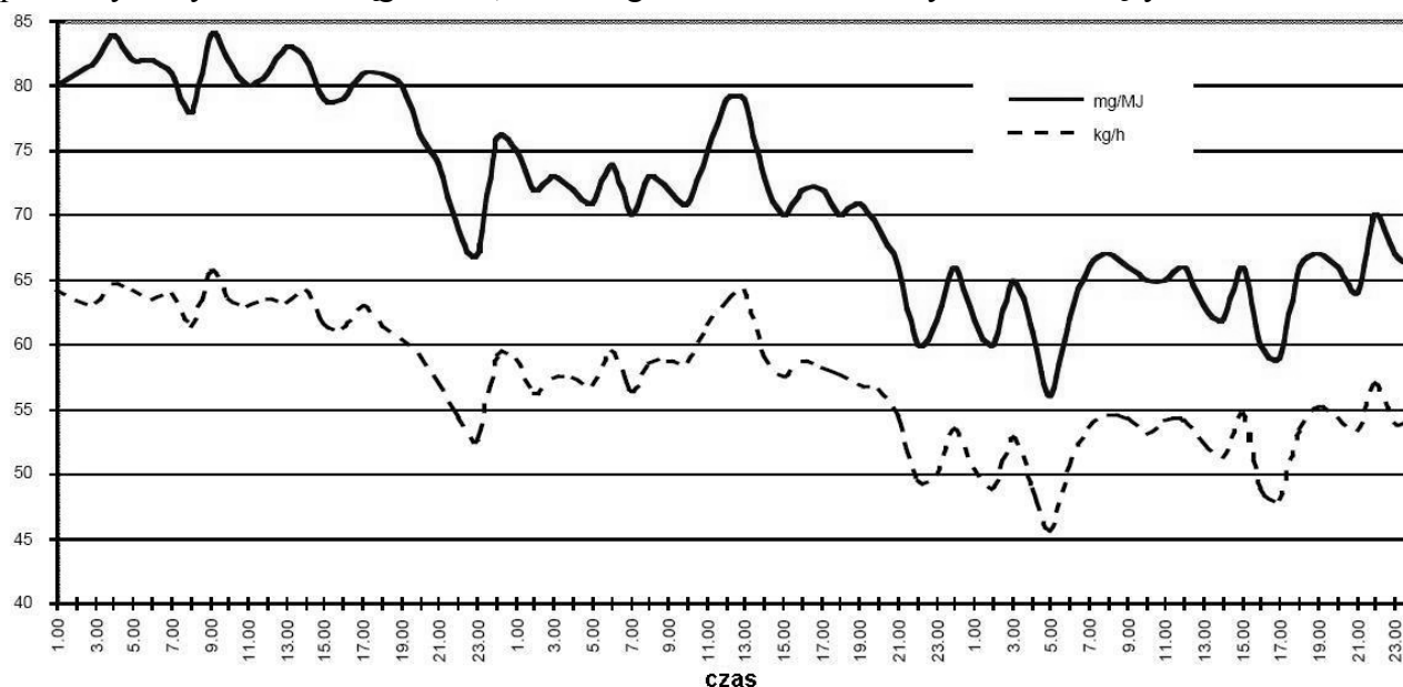
Rysunek IV. 1: Dane z ciągłego monitoringu emisji NOx z siarczanowego kotła regeneracyjnego, w okresie 3 dni
